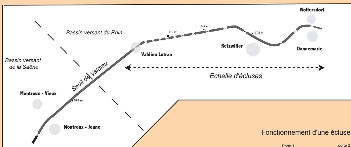
Une échelle de douze écluses entre Valdieu et Wolfersdorf permet aux bateaux de franchir un dénivelé de 30 mètres sur 3 km et d'accéder au seuil de Valdieu.
