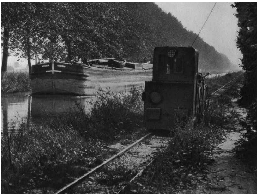
Les loco-tracteurs électriques sur rails de 0.60 sur la berge opposée au chemin de halage.
